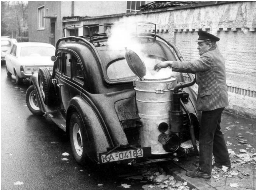
Die Ölkrise fördert nicht selten die Kreativität der Betroffenen: So erleben alternative Kraftstoffe einen vorübergehenden Aufschwung, wie hier bei einem „Adler-Diplomat“ von 1936, der mit Holz und Torf betrieben wurde.
